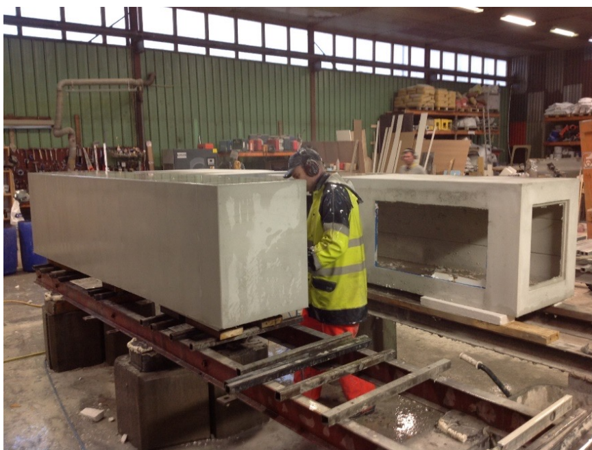
Elementer i GRC(glassfiberbetong). Fra produksjon.
