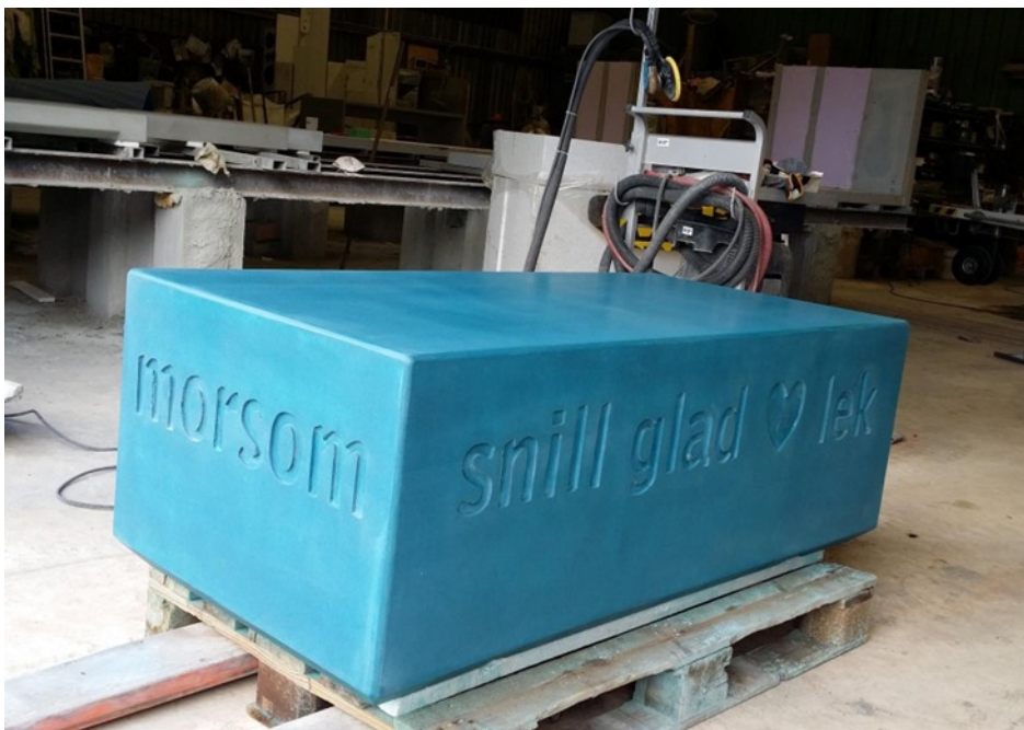
Elementer i GRC med relieff og innfyll farger
