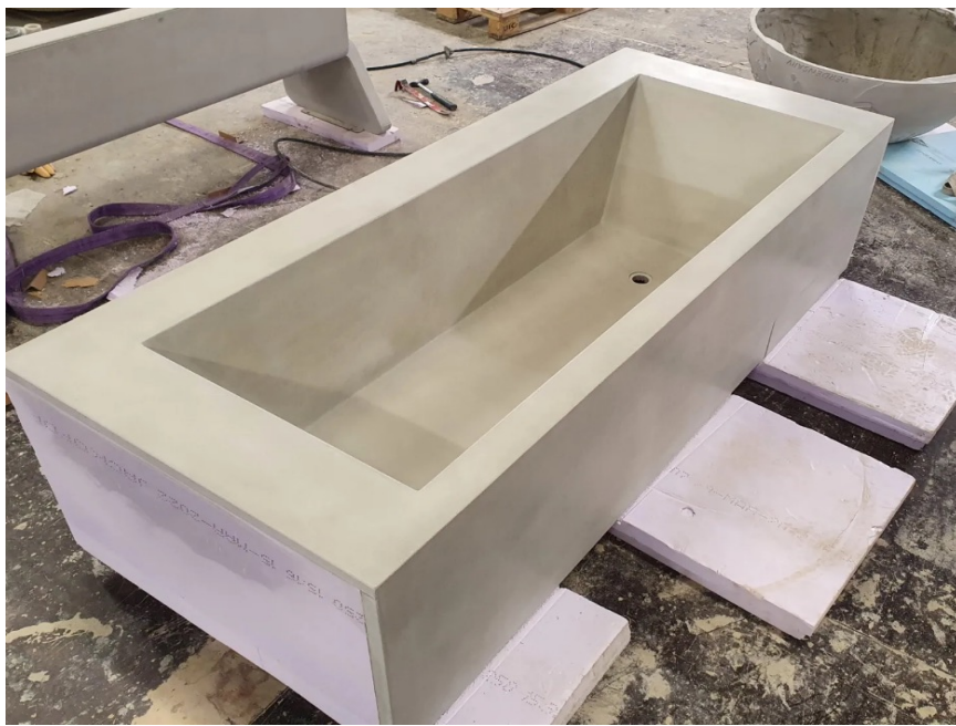
Elementer i GRC(glassfiberbetong). Fra produksjon.
