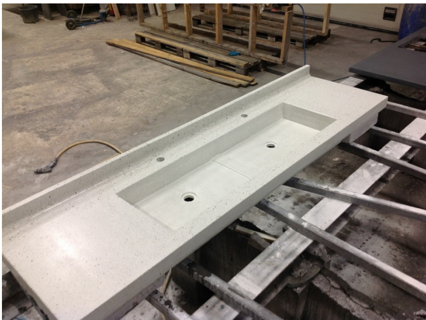
Elementer i GRC(glassfiberbetong). Fra produksjon.
