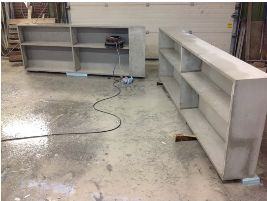
Elementer i GRC(glassfiberbetong). Fra produksjon.
