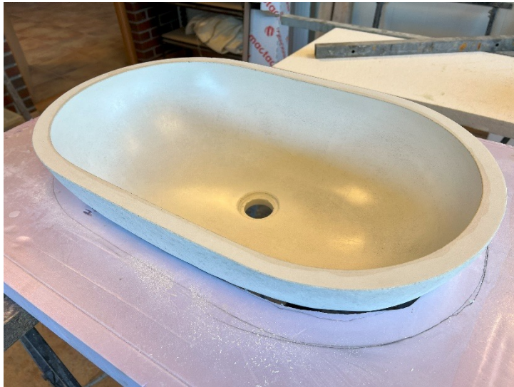
Elementer i GRC(glassfiberbetong) Fra produksjon.
