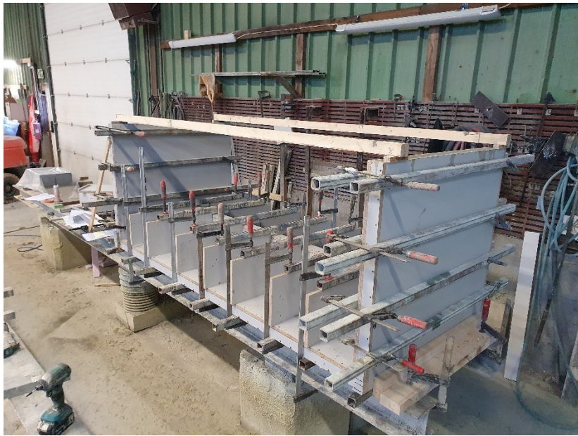
Elementer i GRC(glassfiberbetong) Fra produksjon.
